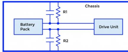
Gambar 4. Hambatan isolasi antara baterai dengan sasis.
